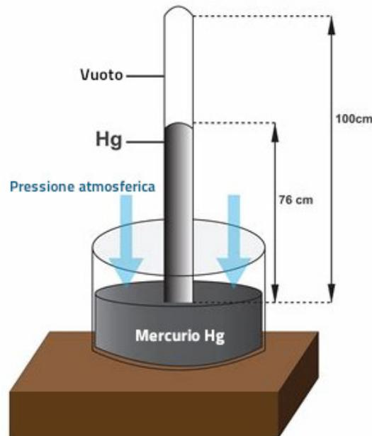
Figure 2. Il barometro di Torricelli - by Wikipedia
